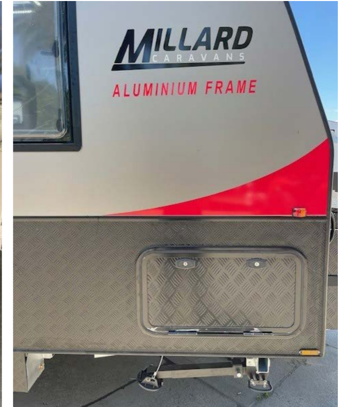
Metal Tunnel boot door
